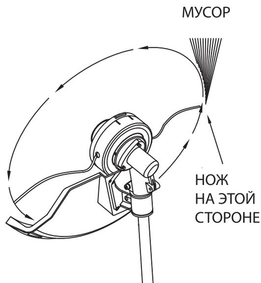
Если триммерная леска вращается по часовой стрелке, то обрезной нож будет расположен на правой стороне защитного кожуха.
