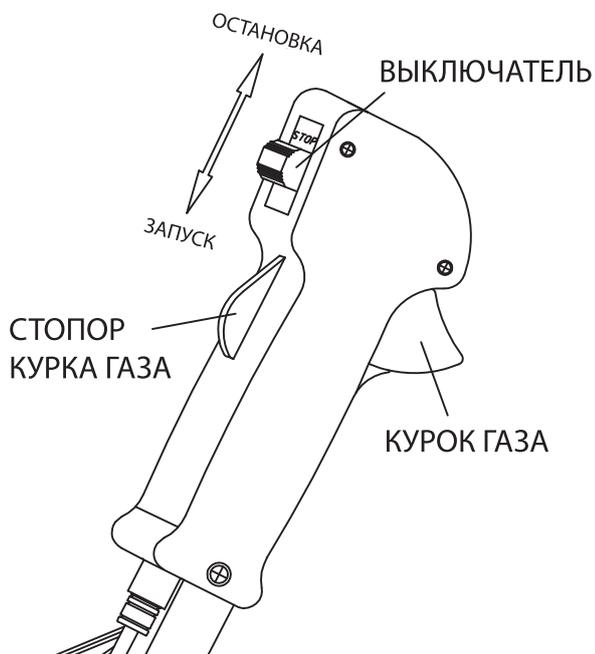
1. Установите выключатель зажигания в положение «START» (запуск).
