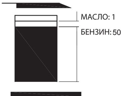
Используйте неэтилированный бензин с октановым числом не ниже 90, смешанный с моторным маслом для двухтактных двигателей Champion, в пропорции 50:1. Для определения пропорций смешивания, используйте ТАБЛИЦУ ПРОПОРЦИЙ ТОПЛИВНОЙ СМЕСИ.
