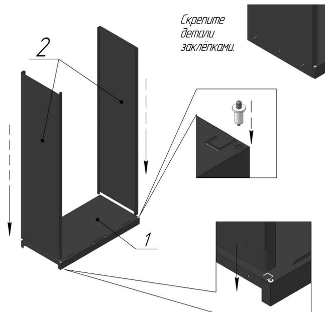
Соедините стенки задние (3) со средней (4) при помощи заклёпок как показано на рисунке, затем разместите их внутри шкафа и закрепите на основании (1) и боковые стенки (2). Установите в крышу (5) пружинные осевые втулки. Наденьте крышу на корпус и соедините все детали заклёпками.
