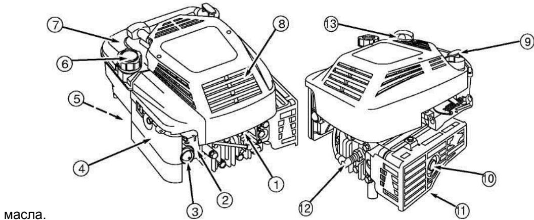
2) Карбюратор, 3) Головка заполнителя (праймер), 4) Воздушный фильтр (плоский), 5) Клапан подачи топлива, если используется, 6) Топливозаливная горловина, 7) Топливный бак, 8) Защитная решетка, 9) Маслозаливная горловина-щуп для измерения уровня масла, 10) Глушитель / (искроуловитель, если используется) , 11) Защитный экран глушителя, 12) Резисторная свеча зажигания, 13) Рукоятка троса стартера.
