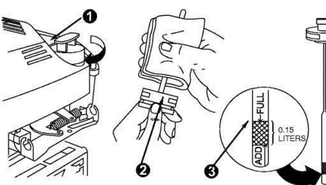
**рис. "Маслозаливная горловина (слева) и щуп-пробка (справа)"**
