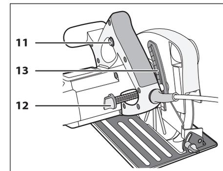
При необходимости ограничения глубины пиления, отпустите винт-барашек 12, отрегулируйте глубину пиления по шкале 13 и затяните винт.
