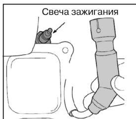
Снимите колпачок свечи зажигания.
