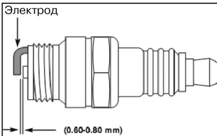
Выкрутите свечу зажигания с помощью свечного ключа.
