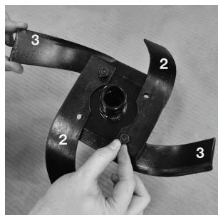
Установите левые фрезы (2) на одной стороне оси(4) и правые фрезы (3) на обратной стороне, сильно зафиксируйте их при помощи болтов (12.5) ,шайб (12.6) и гаек (12.7).
