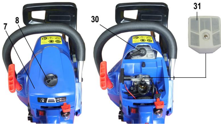
7 – крышка воздушного фильтра; 8 – винт крышки воздушного фильтра; 30 – колпачок свечи зажигания; 31 – воздушный фильтр
