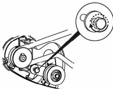
3- Отверните стопорный винт си рычага сцепления (на 2 оборота)
