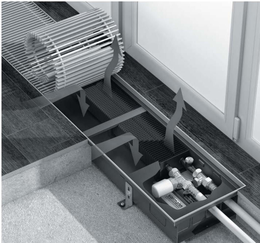
Встраиваемый в пол конвектор Ntherm - это готовый к монтажу отопительный прибор, работающий по принципу естественной конвекции и предназначенный для изоляции от холодного воздуха больших, доходящих до пола окон, а также встраивания в подоконник. Идеален для применения с радиаторами водяного отопления, системами теплого пола и вентиляции.
