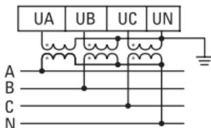
Рис.5 Схема подключения вольтметра через трансформатор напряжения (с помощью четырех проводников,  $nEt=n$  3.4)
