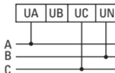
Рис.2 Схема непосредственного подключения вольтметра при  $U \leq 500\text{В}$
