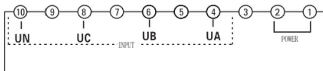
Рис. 7 Обозначение клемм для приборов размером 96x96
