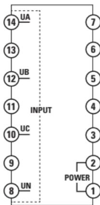
Рис. 6 Обозначение клемм для приборов размером 72x72
