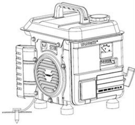
Чтобы предотвратить удар электрического тока от неисправных устройств, генератор должен быть заземлен. Проведите провод большого сечения между клеммой заземления генератора и внешним источником заземления.
