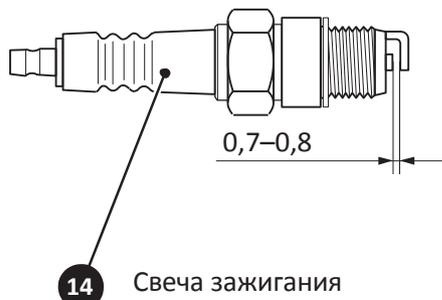
Рис. G — необходимый зазор в свече зажигания.
