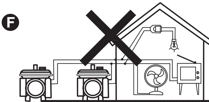
Рис. Е — «Неправильное подключение генератора к промышленной электрической сети — без блокировок».
