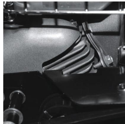
Регулярно очищайте от загрязнений (почва, остатки травы, масло) ребра цилиндра кисточкой и/или баллоном со сжатым воздухом.
