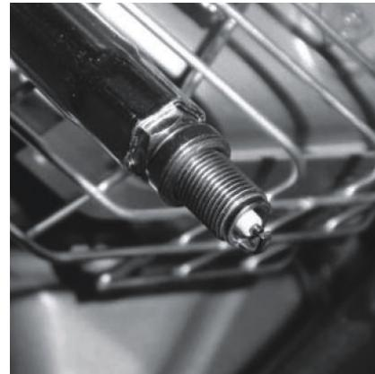
Снимите колпачок высоковольтного провода. Для извлечения свечи из двигателя пользуйтесь свечным ключом из комплекта дополнительных аксессуаров.
