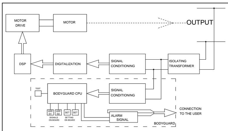
В случае несоответствия выходного напряжения номинальному значению контрольная система генерирует сигнал тревоги, чтобы привлечь внимание пользователя, который должен определить, должна ли активироваться сигнализация или защитное устройство.
