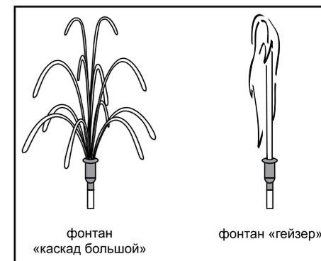
**Примечание!** Форма и высота показанного фонтана являются примерными и могут отличаться в зависимости от мощности насоса, глубины погружения и высоты подачи воды, модели насадки и ее регулировки (для фонтана «колокольчик»).
