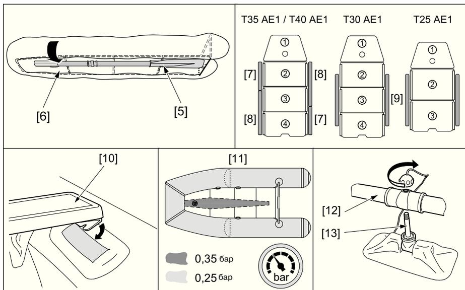
8. Вдвинув весло [5] между днищем лодки и опорной поверхностью, зафиксируйте пайол [6] в плоском состоянии.
