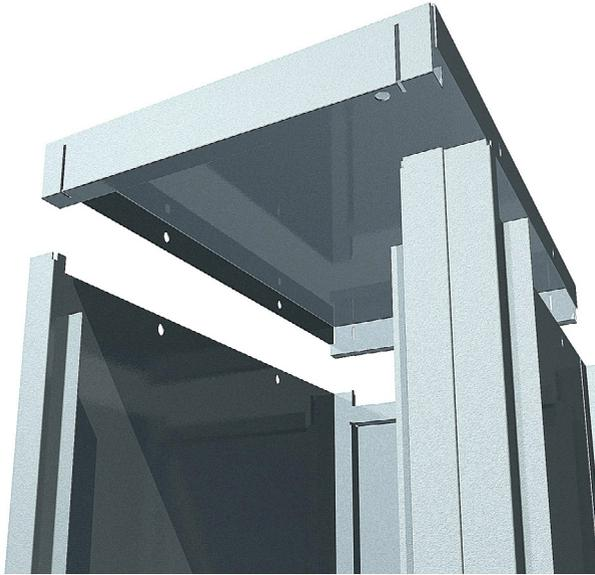
Соединить крыши с боковыми стенками (или перегородками) с помощью винтов с гайками.
