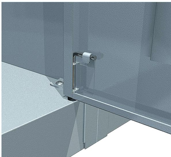
Совместить отверстия в верхней части двери с отверстием втулки крыши, вставить ось и зафиксировать ее, загнув лепесток кронштейна.
