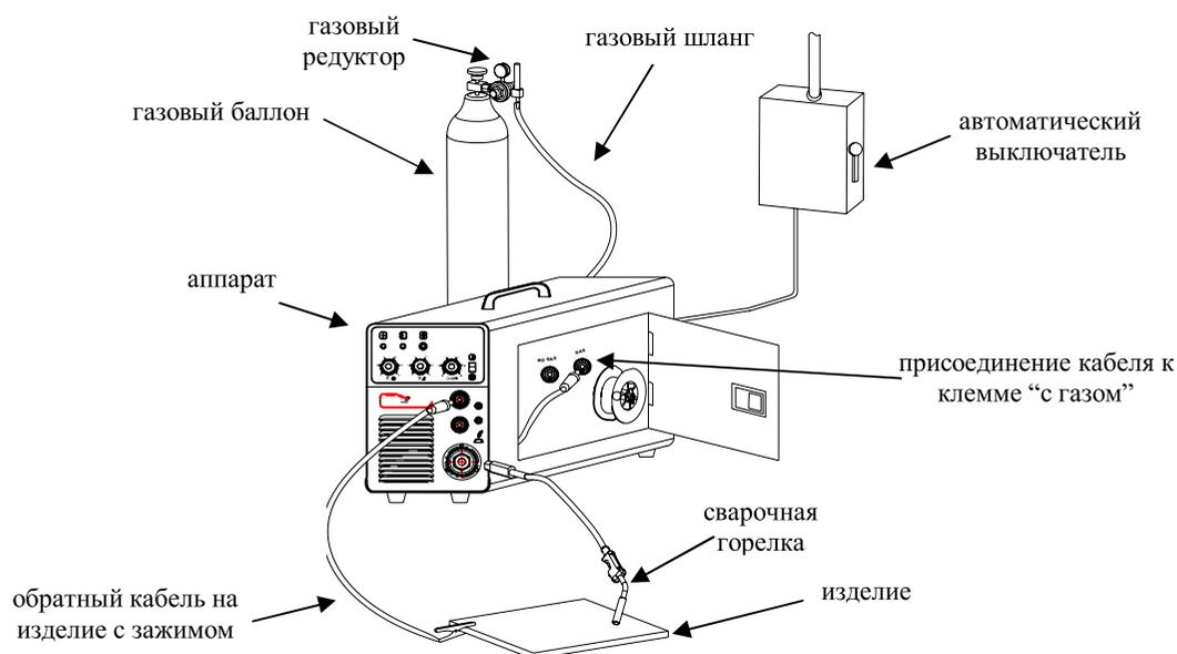
Рисунок 6. Схема установки.
