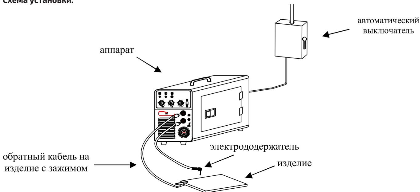
Рисунок 5. Схема установки.
