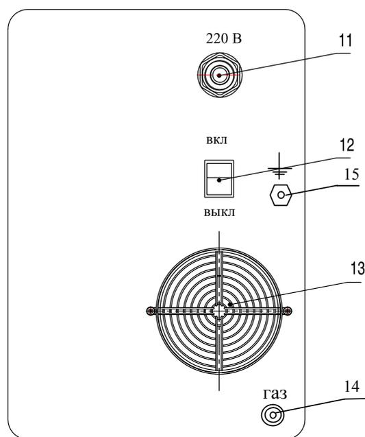
Рисунок 3. Задняя панель.
