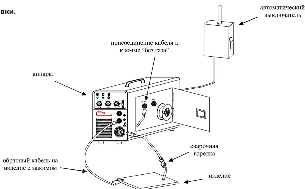
Рисунок 7. Схема установки.
