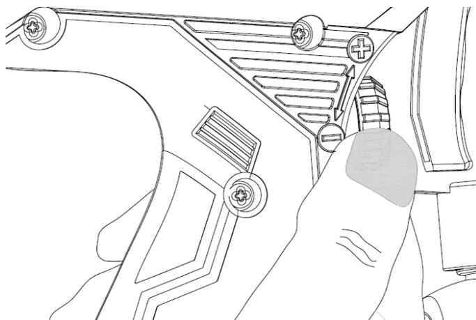
Регулируйте количество подачи распыляемого вещества с помощью колесика. Для увеличения подачи вращайте регулятор по часовой стрелке, для уменьшения против часовой стрелки.
