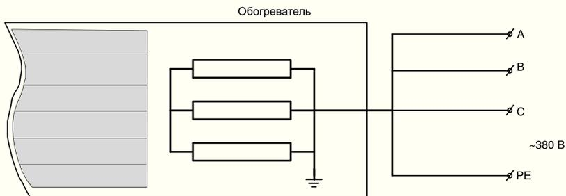
Рис. 3. Обогреватель VIN-AP-3.0; VIN-AP-4.0
