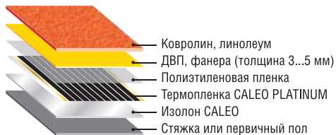
Рис. 4. Схемы монтажа теплого пола CALEO PLATINUM под ламинат, ковролин, линолеум
