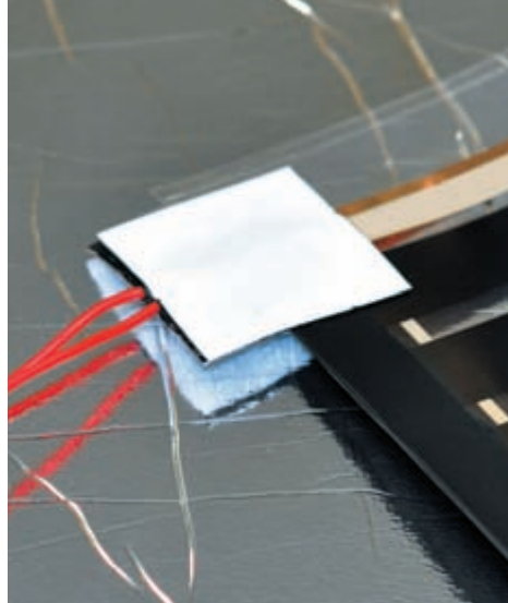
Рис. 20. Вид заизолированного контактного зажима с подключенными проводами
