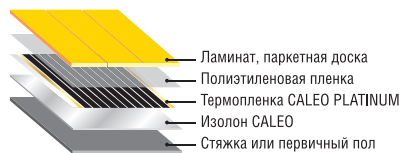
Рис. 28. Схема монтажа пленочного теплого пола под ламинат, паркетную доску
