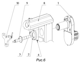
Установите фрезерную голову (1) в посадочное отверстие на стойке станка. Оденьте фиксирующее кольцо (2) на пиноль головы, прикрутите кольцо к держателю винтом (3) и затяните кольцо винтом (4).
