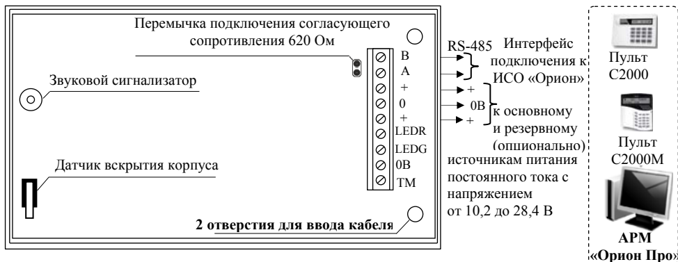
Рисунок 3. Схема внешних соединений блока
