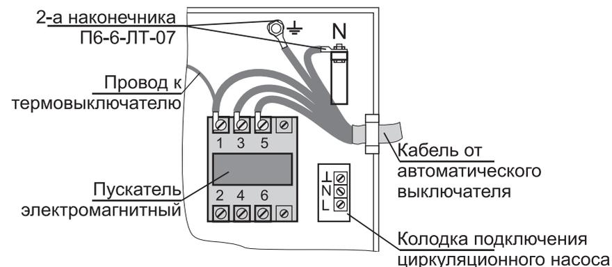
Рис.5. Подключение РусНИТ-206К, 207К, 208К, 209К к трехфазной сети.
