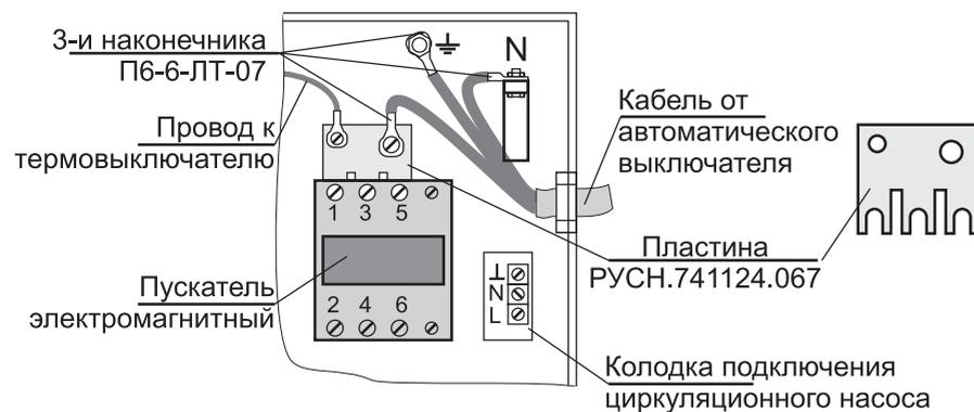
Рис.4. Подключение РусНИТ-206К, 207К, 208К, 209К к однофазной сети.
