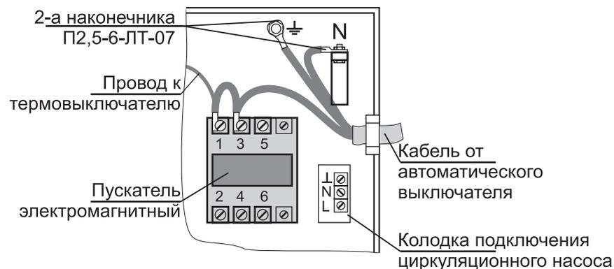
Рис.3. Подключение РусНИТ-205К к однофазной сети.
