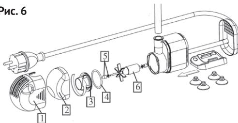
Снимите крышку камеры и выньте керамическое рабочее колесо с ротором 6 (рис.6), преодолевая магнитную силу. При этом внимательно следите за тем, чтобы не потерять резиновые прокладки 4, 5 (рис.6) и не сломать керамическое рабочее колесо. Рабочее колесо тщательно промойте в холодной воде.
