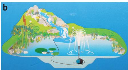
6.5.2 Режим работы “фонтан + каскадный водопад” рис. 5 б и “каскадный водопад”. Только для модели НФЭ - 35. Подключите шланг соответствующего диаметра к выходному штуцеру 7 (рис. 2) на трубке насадки.
