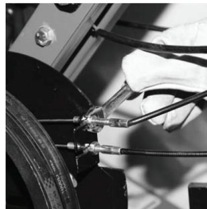
Со временем тросы привода могут растянуться. Для их регулировки необходимо расконстрировать гайки и добиться оптимального натяжения тросов.
