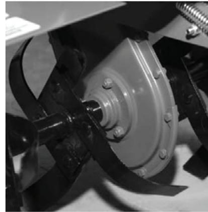
При эксплуатации культиватора при сильной нагрузке или при повышенной температуре окружающего воздуха масло следует заменять каждые 25 моточасов.
