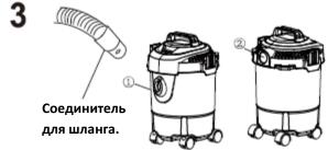
Вставьте соединитель для шланга в отверстие **1**: доступна функция всасывания. Вставьте соединитель для шланга в отверстие **2**: доступна функция продува.
