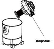
Поднимите защелки, чтобы открыть корпус.
