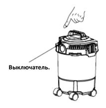
Нажмите на кнопку выключателя для включения/выключения пылесоса.
