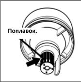
Всасывающий канал оснащен поплавком. При достижении максимально допустимого уровня грязной воды в баке всасывающий поток прерывается.
