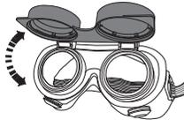
**Газосварочные** очки с непрямой вентиляцией и непотепляющим покрытием. Материал оправы термостойкий ПВХ. Материал линз и светофильтров поликарбонат. Затемнение 5 DIN. Откидной механизм надёжно фиксирует светофильтры в двух положениях.
