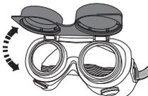
**Газосварочные** очки с непрямой вентиляцией и непотепляющим покрытием. Материал оправы термостойкий ПВХ. Материал линз и светофильтров поликарбонат. Затемнение 5 DIN. Откидной механизм надёжно фиксирует светофильтры в двух положениях.
