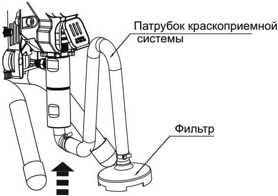
6. Наденьте зажим на дренажную трубку. Затем наденьте трубку на штуцер.
