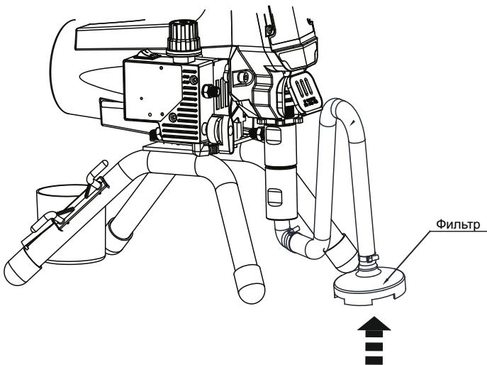
3. Поместите краскоприемную систему в емкость с соответствующей жидкостью для очистки.
