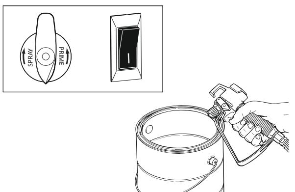
5. Оставьте насос работать для циркуляции жидкости для очистки 2-3 минуты. Затем остановите аппарат.
