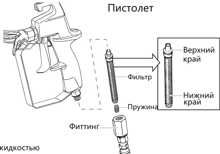
3. Выньте фильтр из пистолета и очистите его моющей жидкостью
