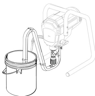
4. Поверните дренажный кран в положение PRIME. Включите аппарат ВКЛ (I). Направьте пистолет в емкость для отходов и нажмите на курок для сброса давления.
