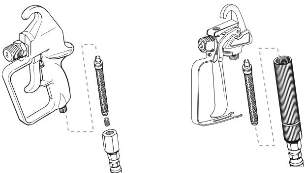
4. Выньте сопло (a) из соплодержателя. Очистите щеткой с жидкостью для очистки. Очистите седло (c) и уплотнение (b). Установите на место в обратной последовательности.
