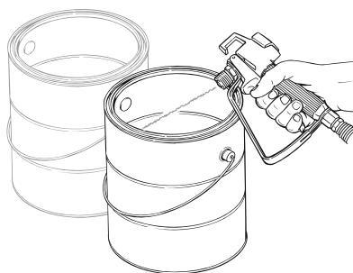
4. Когда уайт-спирит (вода) начнет выходить, направьте пистолет в емкость для отходов (прижмите металлическую часть пистолета к заземленной емкости).
