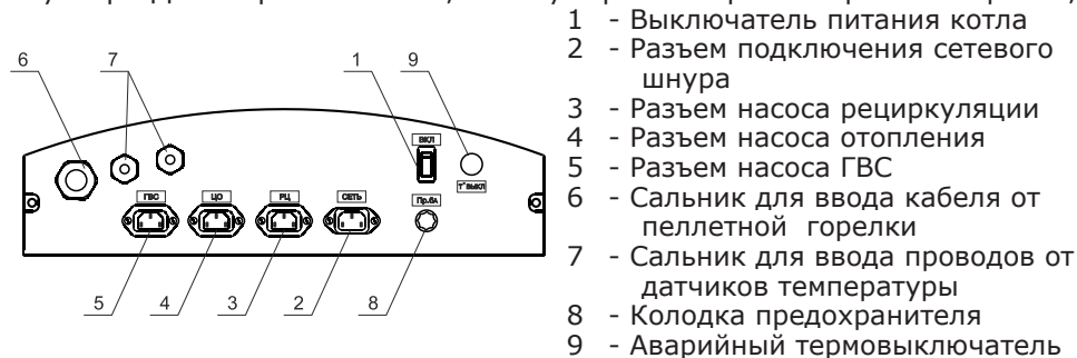
Рис.6 Расположение органов управления на задней панели пульта
