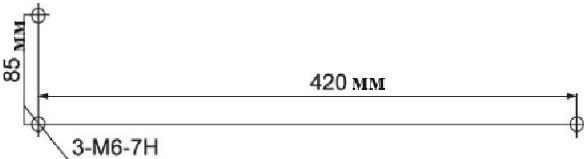
Убедительно рекомендуем надежно прикрепить станок болтами к верстаку, используя резьбовые отверстия для крепления ножек. Это повысит стабильность и, соответственно, безопасность работы.
