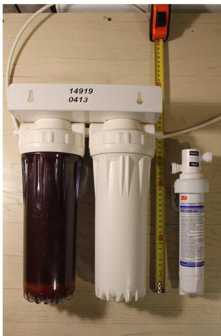
**Сравнительные размеры нового фильтра 3М и магистрального фильтра с двумя 10-дюймовыми колбами**
