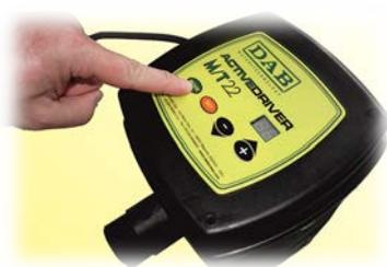
переходим к параметру “AE”, это параметр включения против замерзания и заедания насоса,
