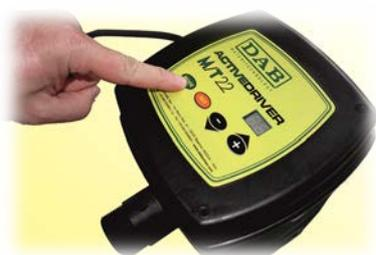
переходим к параметру “FS”, это параметр максимальной частоты вращения насоса, должна уже быть величина 110Гц, потому как номинальная частота уже настроена 110Гц.
