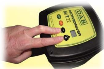
то настраиваем параметры “i1”, “i2”, “i3”, “o1” и “o2” равными 0. Если собираетесь, то для подключения используйте основную инструкцию.
