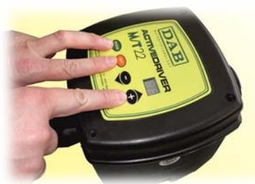
до появления на экране параметра "tB". Это параметр показывает время, через которое Active Driver выйдет в ошибку при отсутствии воды, при первом запуске устанавливаем 10 секунд.
