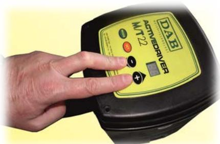
устанавливаем величину 110Гц (обычно уже настроена на заводе). После установки величины 60 Гц, зажимаем кнопку “+” до тех пор, пока величина не будет равна 110Гц.
