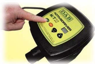
переходим к параметру “GI”, это интегральный коэффициент ПИД-регулятора, оставляем величину, установленную на заводе, она равна 1,0.
