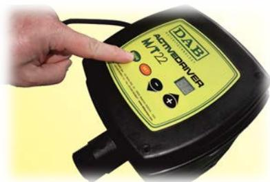
переходим к параметру “Eb”, устанавливаем его “1”.
