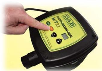
выходим в основное меню, отключаем питание Active Driver и подсоединяем насос. Затем снова включаем Active Driver, система должна запуститься и работать нормально.
