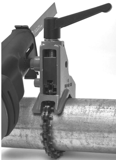
13. ábra – A fűrész felszerelése a támaszra
