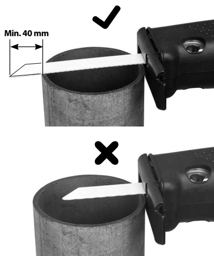
Slika 6 – Pravilna dužina noža
