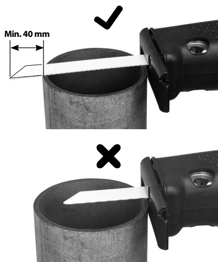
Obrázek 6 – Správná délka pilového listu
