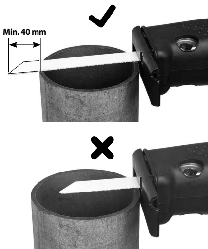
6. ábra – Megfelelő pengehossz
