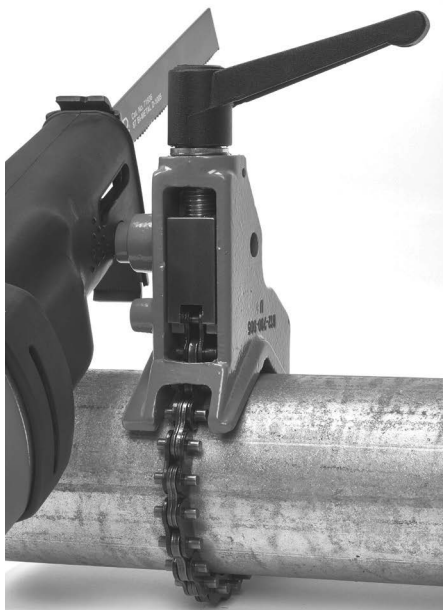
Figur 13 - Montering av sag på støtteenhet
