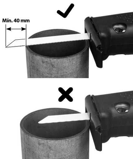
Figura 6 – Comprimento adequado da lâmina
