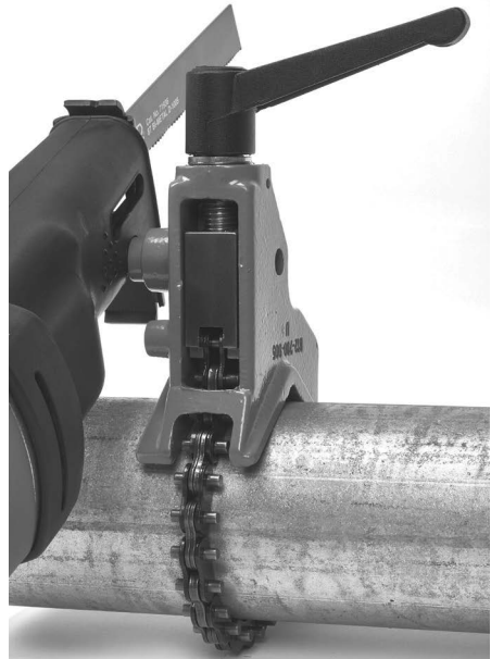
Şekil 13 - Testerenin Destek Cihazına Monte Edilmesi
