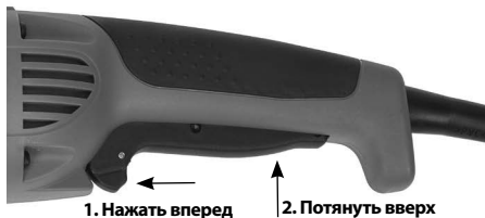
Рис. 9 - Переключение выключателя
