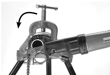
Figur 15C – Skæring af rør
