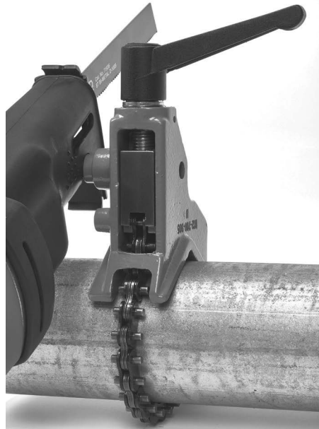
Abbildung 13 – Anbringen der Säge an der Haltevorrichtung
