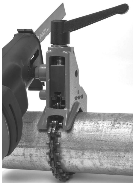
Figura 13 - Montaje de la sierra en el dispositivo de soporte
