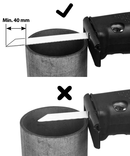
Figur 6 - Korrekt bladlengde
