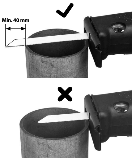
Figura 6 – Lunghezza corretta della lama
