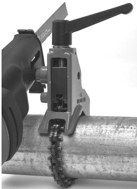
Obrázek 13 – Montáž pily na podpěrné zařízení
