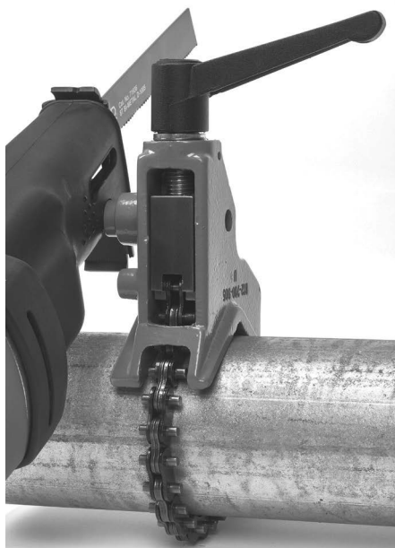
Εικόνα 13 – Τοποθέτηση του ταχυπρίονου στον μηχανισμό αντιστήριξης
