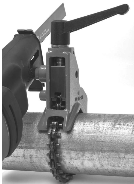
Рис. 13 - Установка пилы на фиксаторе
