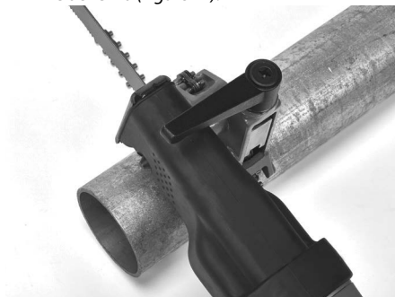
Figure 12 – Positionnement du dispositif de support avec alignement sur l'emplacement de la découpe souhaitée
