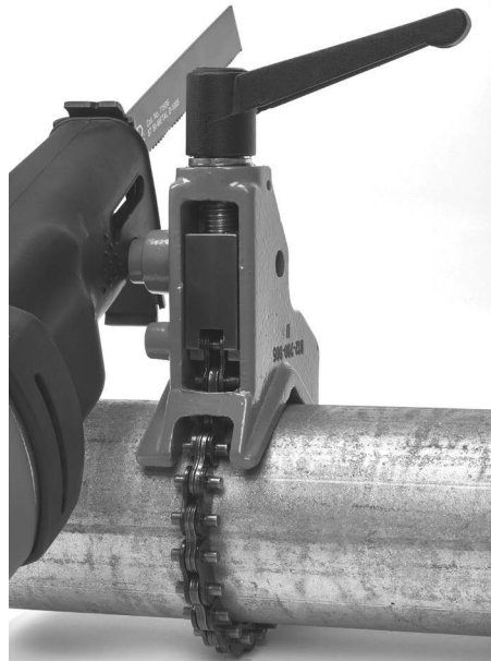
Figur 13 – Montering af sav på støtteanordning (kædeskruestik)
