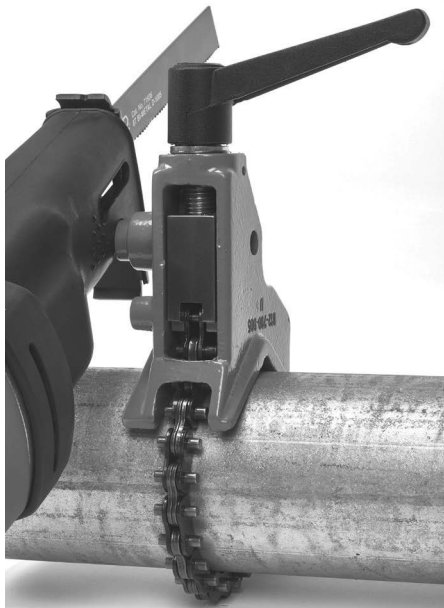
Figuur 13 – Pendelzaagmachine op het steunhulpstuk monteren
