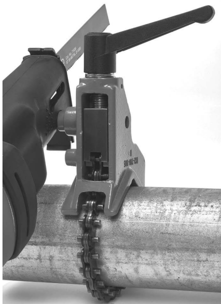
Slika 13 – Montaža testere na uređaj za oslanjanje
