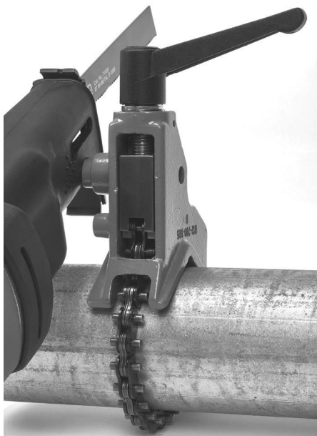
Kuva 13 – Sahan kiinnittäminen tukilaitteeseen
