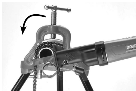
Рис. 15С- Резка трубы
