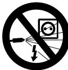
**Электрические приспособления, соединения и токопроводящие провода не обрызгивать высоконапорной струей либо с использованием шланга для воды – опасность короткого замыкания!**
