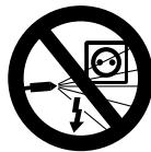
Nu stropiți cu jetul de înaltă presiune sau cu furtunul cu apă aparatele electrice, racordurile și cablurile străbătute de curent – **pericol de scurtcircuitare!**
