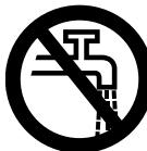
Visokotlačni čistač se ne smije direktno priključivati na opskrbnu mrežu s vodom za piće.
