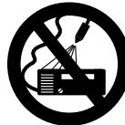
Nie spryskiwać strumieniem wody pod wysokim ciśnieniem lub wodą z węża samego urządzenia ani innych urządzeń elektrycznych – **niebezpieczeństwo powstania zwarcia w instalacji!**
