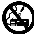
Nu stropiți cu jetul de înaltă presiune sau cu furtunul cu apă aparatul propriu-zis și alte electro-utilaje – **pericol de scurtcircuitare!**
