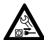
Prije svih radova na uređaju: mrežni utikač izvući iz utičnice.
