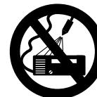
Сам агрегат, другие электроприборы никогда не обрызгивать высоконапорной струёй либо с использованием шланга для воды – **опасность короткого замыкания!**
