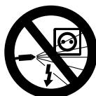
Nie spryskiwać strumieniem wody pod wysokim ciśnieniem lub wodą z węża urządzeń elektrycznych, przyłączy lub przewodów pod napięciem – **niebezpieczeństwwo powstania zwarcia w instalacji!**
