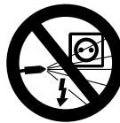
Električna postrojenja, priključke i strujne vodove ne prskati s visokotlačnim mlazom ili sa crijevom za vodu – **opasnost od kratkog spoja!!**
