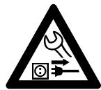
Перед началом проведения работ на агрегате: извлечь штепсельную вилку из розетки.
