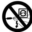
Nie spryskiwać strumieniem wody pod wysokim ciśnieniem lub wodą z węża instalacji elektrycznych, przyłączy lub przewodów pod napięciem — **zagrożenie wystąpieniem zwarcia!**
