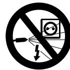
Nu stropiți cu jetul de înaltă presiune sau cu furtunul cu apă aparatele electrice, racordurile și cablurile străbătute de curenț – **pericol de scurtcircuitare!**
