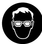
Aby zmniejszyć niebezpieczeństwo odniesienia obrażeń oczu, należy zakładać ciasno przylegające okulary ochronne zgodnie z normą EN 166. Zwracać uwagę na prawidłowe założenie okularów ochronnych.
