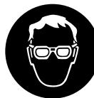
Pentru reducerea riscului de leziuni la ochi, purtați ochelari de protecție cu aplicare strânsă conform normei EN 166. Aveți grijă la corecta așezare a ochelarilor de protecție.
