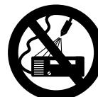
На сам агрегат, а также на другие электроприборы запрещается направлять высоконапорную струю или струю водяного шланга – **опасность короткого замыкания!**
