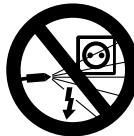
Электрооборудование, соединения и токопроводящие провода не обрызгивать струей из высоконапорного или водяного шланга – **опасность короткого замыкания!**
