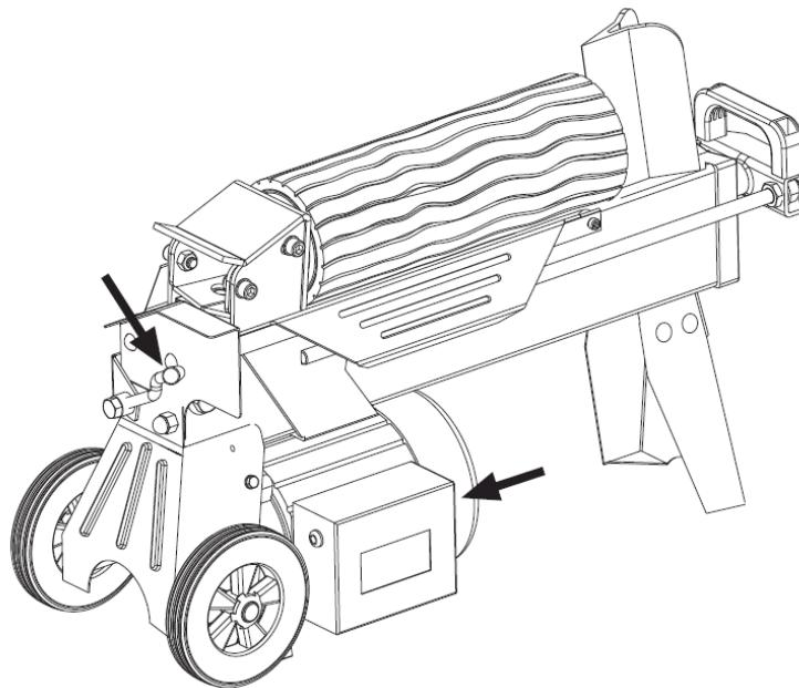
**Не увеличивать давление в станке более 5 секунд при рубке слишком твердых бревен.**
