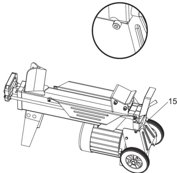
Дровокольный станок оборудован системой управления ZHB, которая предполагает использование оператором обеих рук – левой рукой осуществляется управление рычагом гидроуправления, правой рукой – управление кнопочным переключателем.
