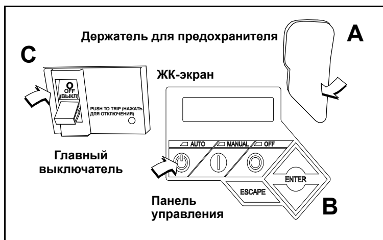
Рис. 5-16. Панель управления генератора
