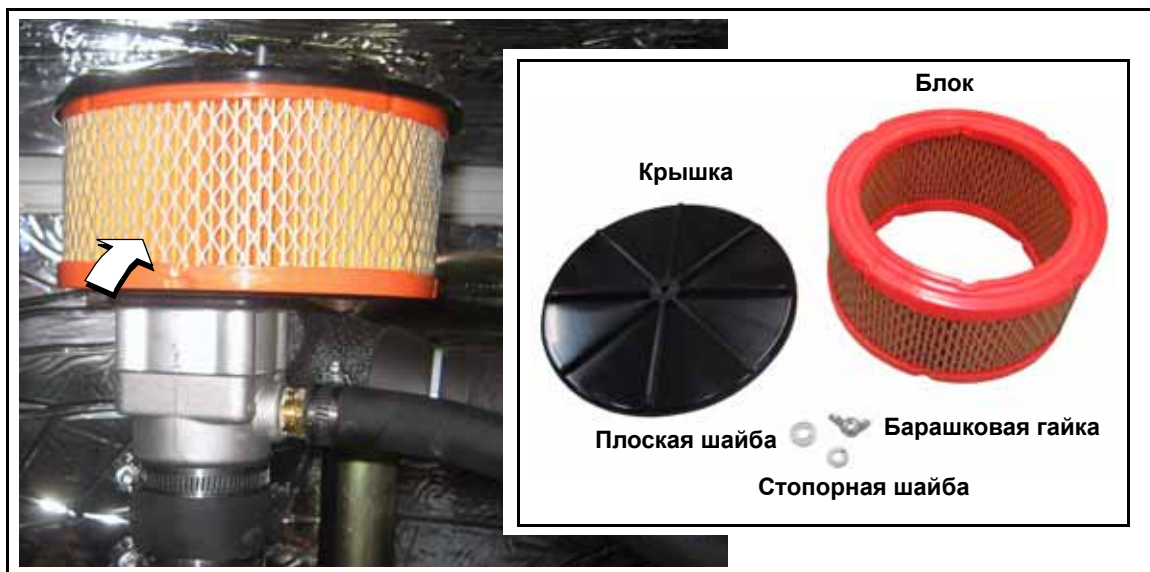
Рис. 5-13. Крышка воздухоочистителя и блок фильтра
