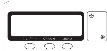
ON/OFF – включает и выключает прибор. Прибор отключится автоматически через 5 мин простоя.
