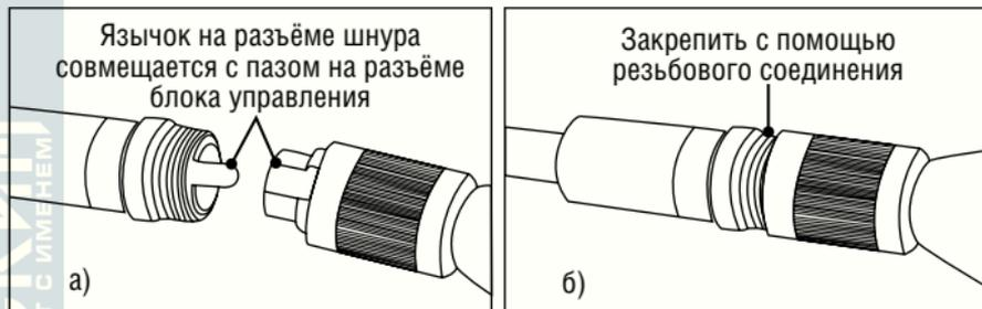
Рисунок 4 - Подсоединение гибкого зонда к монитору
