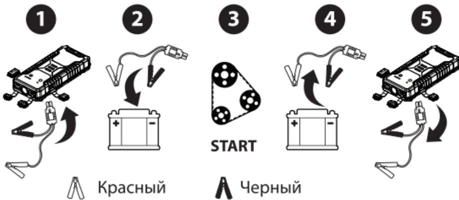
1. Убедитесь, что заряд пуско-зарядного устройства ПускАч достаточен для запуска вашего двигателя. Рекомендуется иметь уровень заряда более двух светодиодов (для мощных двигателей уровень заряда должен быть полным). Включите устройства переведением выключателя в положение ON. А также подключите комплектные кабели типа «крокодил» к 12В пусковому разъему
