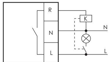
Схема включения при подключении нагрузки более 30А.
