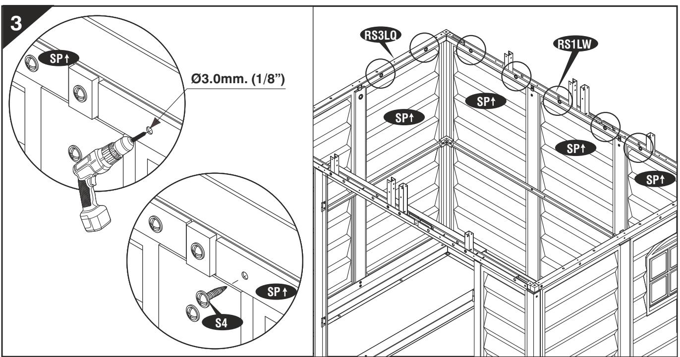
Присоедините каждую боковую панель (SP↑) вверху к конструкции крыши (RS1LQ, RS1RQ, RS3LQ & RS3SQ). Используя электрическую дрель со сверлом диам. 3 мм, сделайте два отверстия на равном расстоянии на боковой панели сквозь конструкцию крыши. Ведите саморез (S4) через боковую панель к конструкции крыши. Повторите эту процедуру для каждого боковой панели. См. схему.
