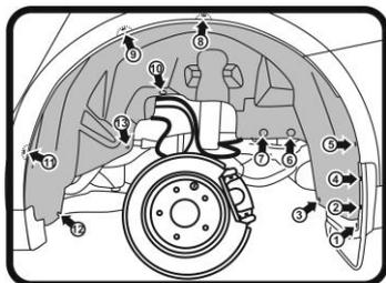
Взять подкрылок, соответствующий арке крыла и поместить его внутрь колесной ниши, заправив под кромку колесной арки, порог и брызговик
