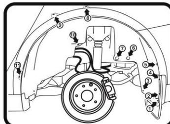
Выкрутить саморезы (1,2,4,5), выкрутить штатные гайки (6,7,8,9), демонтировать пистоны (3,10,11).
