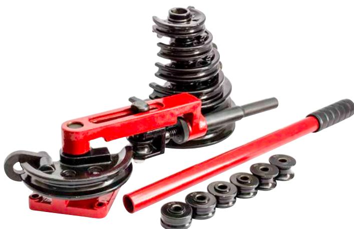
Применяется для придания нужных углов для сантехнических, газовых и прочих металлических труб без деформации профиля. Для точной холодной гибки под углом до 90° труб для систем газо-, водоснабжения и котельных труб диаметром от 3/8 до 1" в соответствии с DIN2440 и 2441.
