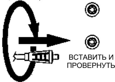
Подсоединить контактный зажим массы к отрицательному гнездовому контакту, а кабель электрододержателя к соответствующему положительному гнездовому контакту.
