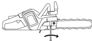
Цепь считается натянутой правильно, если она не провисает снизу и если ее можно проворачивать рукой. Затяните гайки на шине пилы универсальным ключом, удерживайте при этом носок шины пилы рукой.
