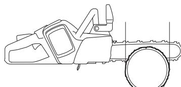
Существуют методы валки деревьев с полотном, меньшим диаметром ствола. Однако эти методы достаточно опасны, т.к. область отдачи полотна входит в контакт с предметом.
