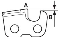
При затачивании режущего зуба, следует учитывать четыре параметра.
