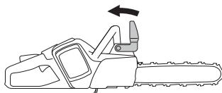
Отверните гайку крепления шины пилы и снимите крышку ведущей звездочки. Снимите транспортировочное ограждение (A).
