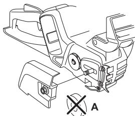
Смонтируйте шину пилы на специально предназначенном болте. Установите шину пилы в самое заднее положение. Оденьте цепь на ведущую шестерню и вставьте ее хвостовики в паз шины пилы. Этую операцию следует начать с верхней стороны шины пилы.
