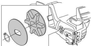
Следует регулярно проверять степень износа звездочки привода. Заменять при сильном износе.
