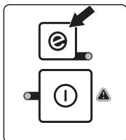
Обратите внимание! Использование машины с активированной функцией энергосбережения SavE уменьшает только скорость цепи, но не снижает режущую способность самой машины.
