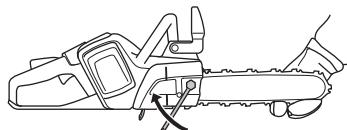
При установки новой цепи следует часто проверять ее натяжение, пока цепь не приработается. Регулярно проверяйте натяжение цепи. Регулярно проверяйте натяжение цепи. Правильно натянутая цепь обеспечивает высокое качество пиления и дольше служит.
