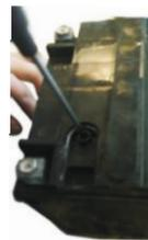
3. Распакуйте емкость с электролитом и снимите защитную фольгу с выводных отверстий
