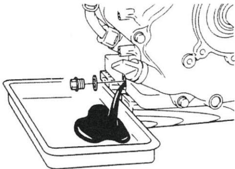
3. После слива старого масла завернуть сливную пробку на место и снова установить генератор в горизонтальное положение.
