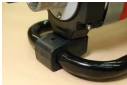
Виброизоляция рамы, резиновые амортизаторы.
