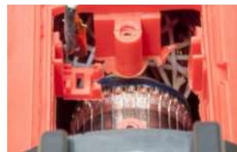
Защита ротора от частиц пыли (дополнительный бандаж).
