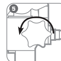
Для сброса давления поверните дроссельный винт в положение «Открыть»
