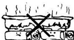
Не допускайте перегревания. Посуда, занимающая поверхность большую, чем нагревательная часть, может послужить причиной перегрева плитки.
