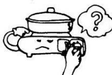
Варочная решетка должна быть готова к работе и регулятор должен находиться в выключенном положении OFF перед тем, как рычаг будет приведен в рабочее положение. Если любое из этих условий не соблюдено, рычаг газового крана не повернется вниз.
