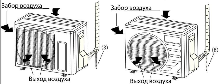
Примечание: наружный блок имеет два исполнения.
