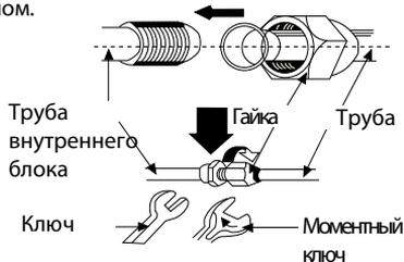
ПРИМЕЧАНИЕ: в первую очередь производится подключение соединительного трубопровода к внутреннему блоку, а потом к наружному. Не допускайте изгибов и повреждений трубы.
