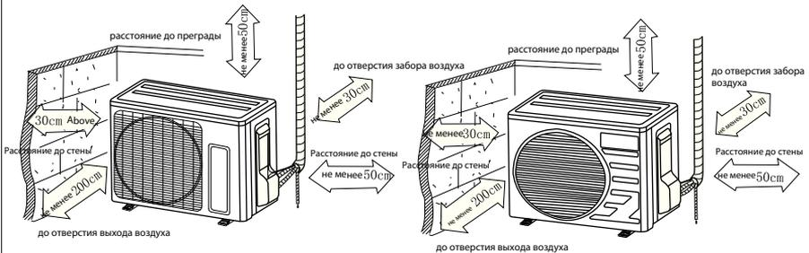
Примечание: наружный блок имеет два исполнения
